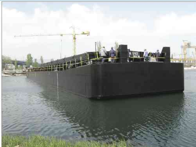
На 29 април т.г. в Завода за корабно машиностроене АД – Варна, бе спусната на вода четвъртата 2000-тонна несамоходна баржа (стр. № 104) за нуждите на Параходство Българско речно плаване. След приключване на довършителните дейности баржата бе отбуксирана до Русе.
